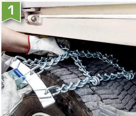
Positionner la chaîne autour du pneu et passer la sangle derrière la roue.
