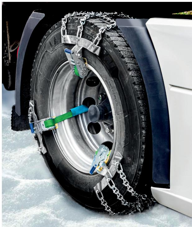
Répéter l'opération afin que la roue soit équipée de 3 systèmes SNOWCRAMP XXL®, puis faites de même sur la seconde roue motrice du même essieu.
