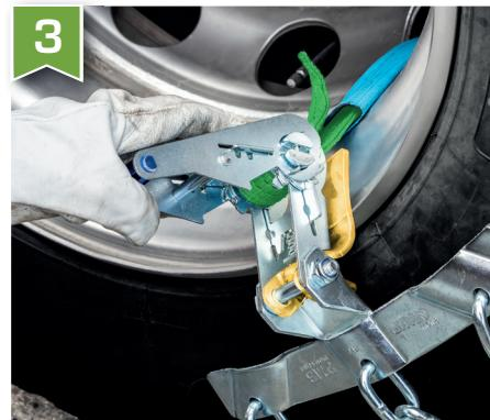
Tendre la sangle à l'aide du tendeur, jusqu'à ce que la SNOWCRAMP XXL® soit solidement fixée contre le pneu
