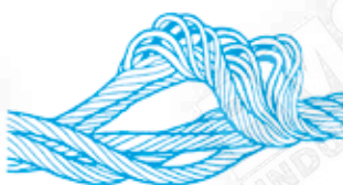
Cage d'oiseau résultant d'un coincement au passage sur une poulie
