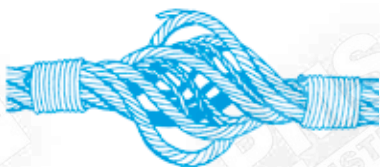
Cage d'oiseaux (câble à 6 torons) causée par des chocs lors de travail sous charge
