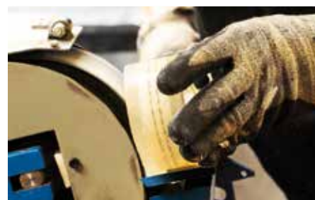
Ponçage d'une sangle enduite de polyuréthane.
