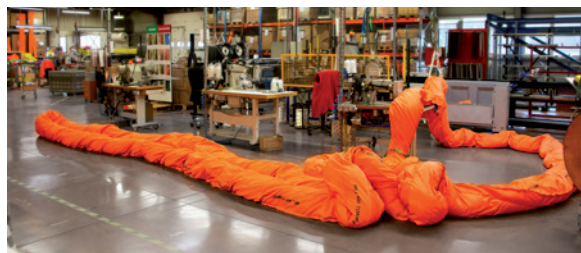
Fabrication d'une élingue 400 tonnes - 28 mètres
