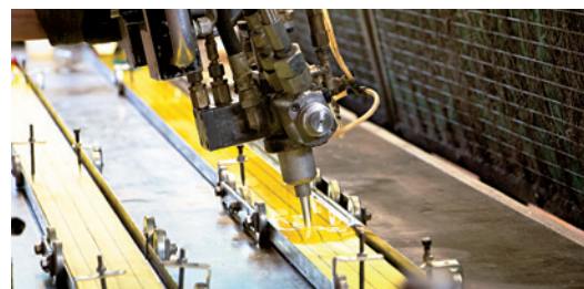
Enduction de polyuréthane sur une sangle plate.
