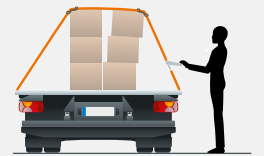
Avec un tendeur à détente progressive.
