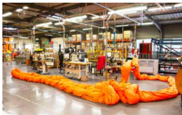
Élingue ronde 400 tonnes, 15 mètres (fabriquée dans notre atelier à Rang - département 25)
