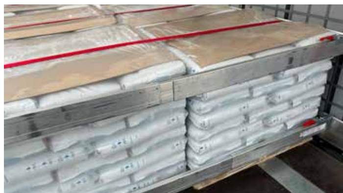
Barre savoyarde mise en place dans un camion.
