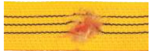
Fils visibles lorsque l'élingue est usée et donc hors service
