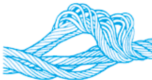
Cage d'oiseau résultant d'un coincement au passage sur une poulie
