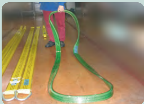
» Réalisation d'une enduction sur une élingue sangle plate sans fin.
