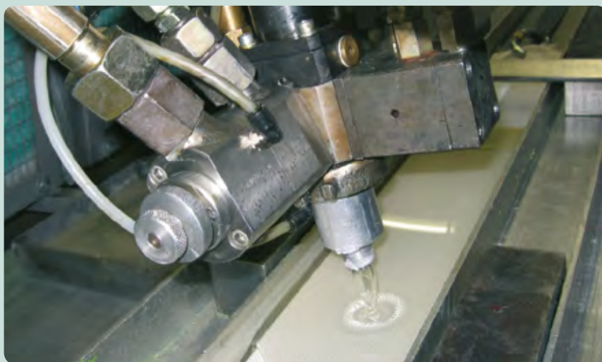
» Réalisation en cours d'un fourreau polyuréthane POLYSAFE 2 faces.
